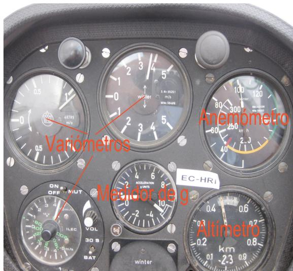
**Anemómetro.** Mide la velocidad con que se mueve el avión dentro de la masa de aire en la que se mueve. Sólo los días de calma absoluta las velocidades coinciden. (km/h) ¿entiendes la razón?
